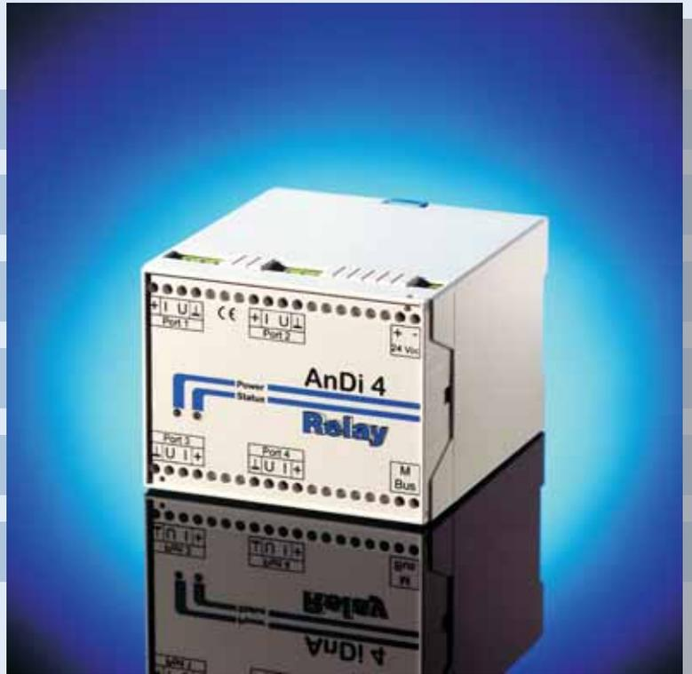
Der AnDi4 ermöglicht über Ihre M-Bus Installation eine Erfassung von analogen Meßgrößen, wie zum Beispiel Druck, Temperatur oder Drehzahl. Dabei können handelsübliche Industriesensoren mit 0/4..20mA oder 0..10V Signalen verwendet werden.
