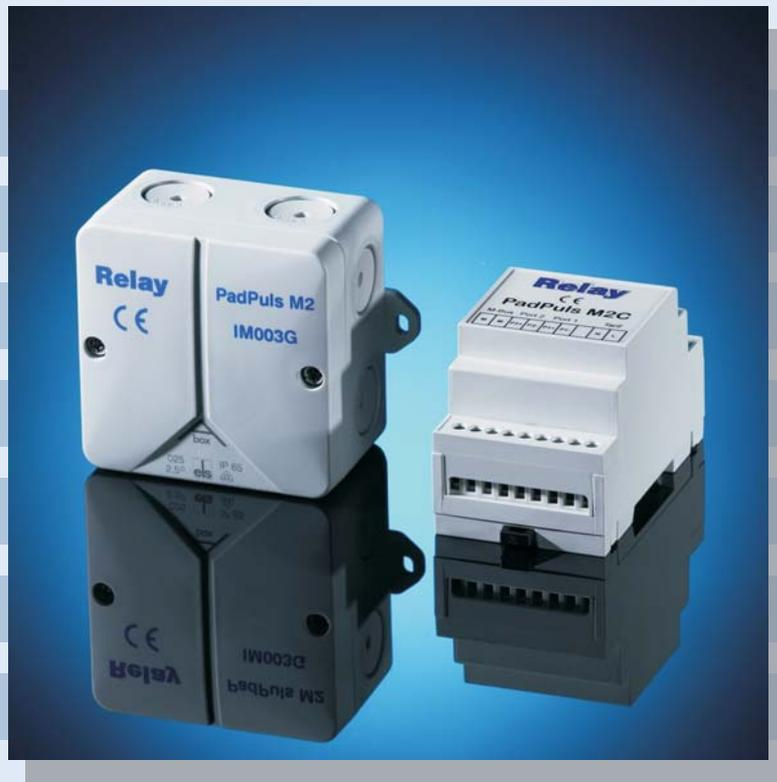
Die Geräte der Baureihe PadPuls M2 adaptieren bis zu zwei konventionelle Meßgeräte mit Impulsausgang an ein M-Bus System. Die zwei Zähl-Eingänge lassen sich nahezu beliebig parametrieren und somit an bestehende Installationen anpassen.
