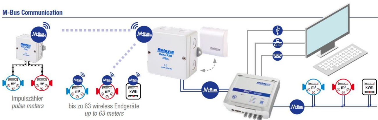
Abbildung: Wireless M-Bus System mit PadPuls M2W, RelAir R2M Gateway und PW250
