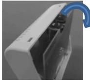
Nun wird die Leiterplatte durch Ziehen an der Kante des halbkreisförmigen Ausschnittes aus der Frontabdeckung gekippt.
