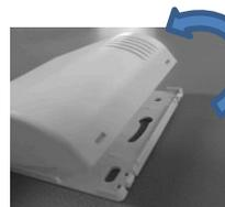
Wiederholen Sie diesen Vorgang bei der zweiten Rast-Nase. Danach kann die vordere Abdeckung von der Montageplatte abgehoben werden.
